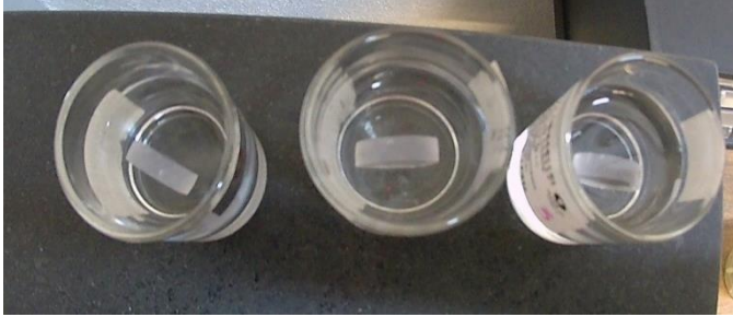
Figura 4: Inmersión total de las probetas de PC en agua destilada.
