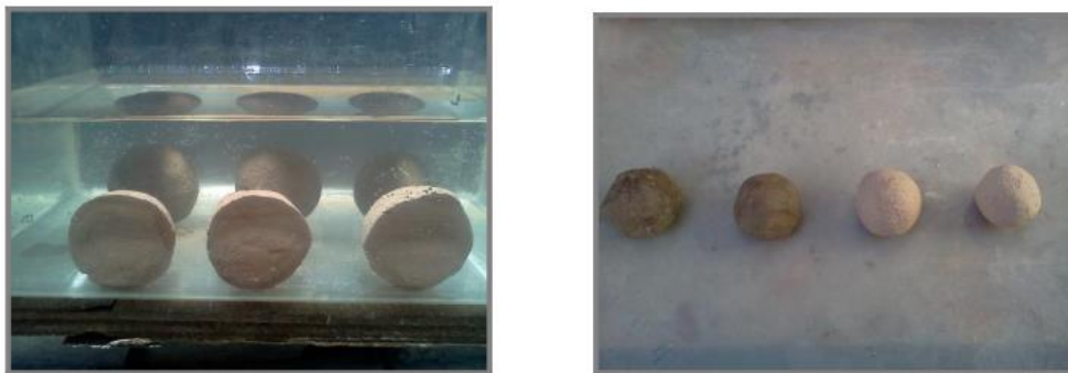
Figura 4: Pastas de cemento sometidas al ensayo de hidraulicidad
