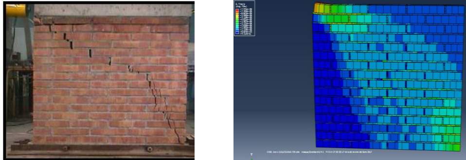
Figura 1: a) Modelo experimental 150V80H y b) Modelo numérico 150V80H. La diferencia porcentual entre el modelo numérico y el experimental fue de 13,57% (Ver gráfico 1).
