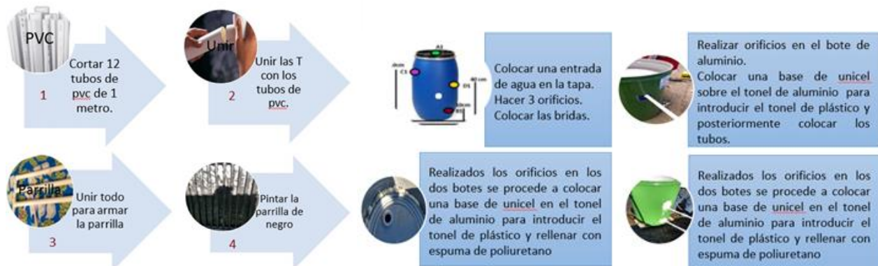
Figura 1. a) Elaboración de la parrilla, b) Elaboración del termo tanque Se construyó el calentador iniciando con la parrilla, para ello fue necesario cortar 12 tubos de pvc de 1 metro de largo, se unieron los tubos utilizando T's también de pvc, una vez que se armó la parrilla se pintó de negro para absorber mayor cantidad de energía solar. Después se construyó el cajón para la parrilla, se hizo un marco
