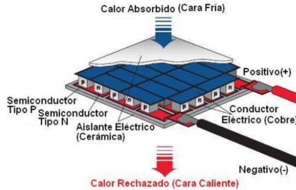
Fig 16. Diagrama de la estructura interna del efecto peltier.
