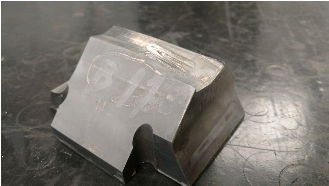
Figura 3.- Vista isométrica de un martillo para forjado en frío, donde puede apreciarse la falla por deformación plástica
