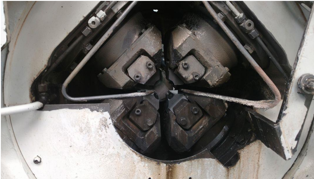
Figura 1.- Caja de forjado con el juego de cuatro 4 martillos y soporte de contador
