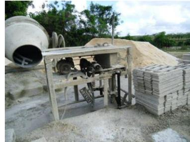
Fotos 4 y 5 Máquinas de hacer bloques
