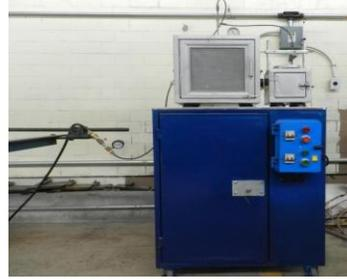
Fig. 2 Tribómetro erosionador construido por el grupo de tribología de la SEPI-ESIME-ZAC-IPN.
