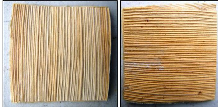
**Figura 1.** Sentido de las fibras en las probetas
