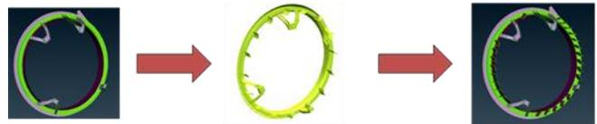
**Figura 15.** Optimización del anillo de soporte de la tolva y álabes incorporados a la geometría para la mejora del flujo de aire
