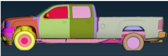
**Figura 18.** Vista lateral del modelo de CFD. Vehículo completo escala 1:1 construido para análisis de sensibilidad y robustez
