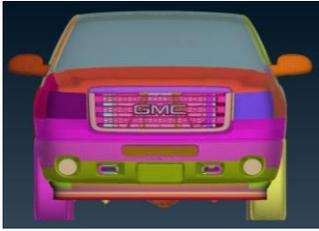
**Figura 17.** Vista frontal del modelo de CFD. Vehículo completo escala 1:1 construido para análisis de sensibilidad y robustez
