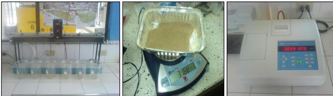
Figura 1 – Equipos de laboratorio para coagulación – Empresa IBAL S.A. E.S.P.
