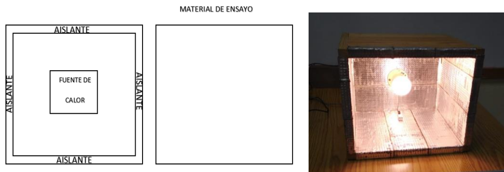
Figura 1 Esquema y prototipo de medidor de conductividad térmica.
