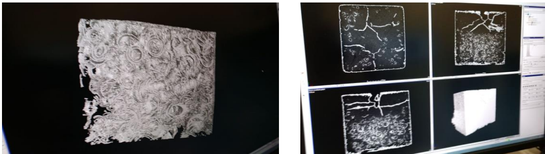
Fig. 2. Imagen del tomografía computarizada, material compuesto PET.
