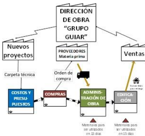
Figura 13. VSM general del proceso de fabricación de una vivienda de Grupo Guiar.
