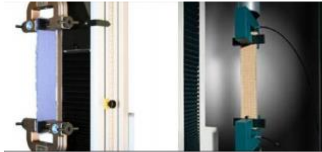
Ilustración 0-4 Mordaza para el método de tiras
