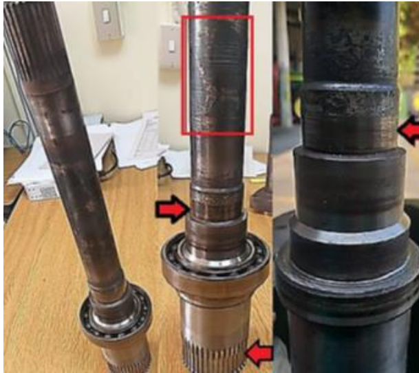
Figura 15. Puntos de averías del eje YZ9406 de la transmisión TSS
