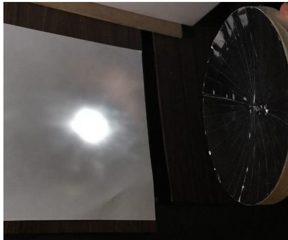
Figura 4. Superficie reflectora bajo prueba con un Diodo emisor de luz de alta potencia de 100Watts.
