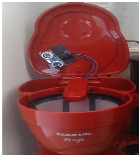
Figura 8. Sensor de nivel de agua.
